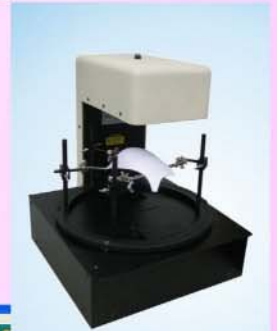
應用激光測厚機 補償縮水及變形
